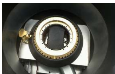
Wok equipado con quemadores de 12kw de potencia
